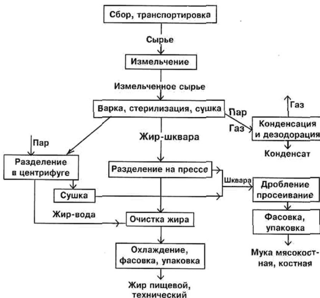
Рис. 2. Базовая схема переработки отходов животного происхождения [4]
